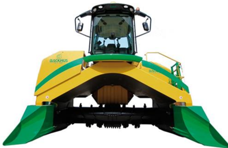
Figura 6 – Sistema móvel de reviramento para leiras triangulares
