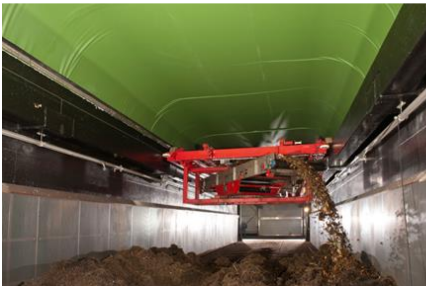
Figura 13 – Túnel de fermentação com sistema de carregamento automatizado
