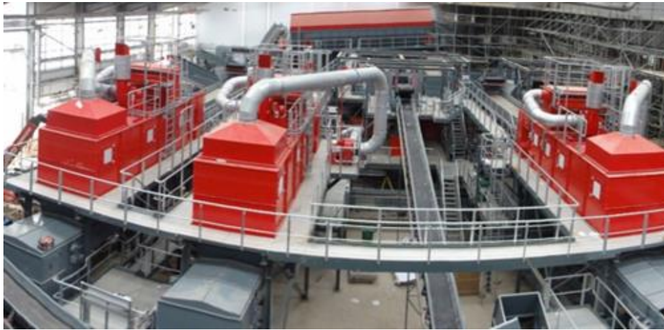
Figura 4 – Sistema de separação por fluxos de ar, durante a produção de CDR
