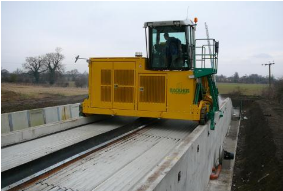
Figura 10 – Sistema de reviramento de linhas, linha fechada ( Lane Turner Closed )
