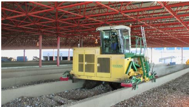
Figura 7 – Sistema de reviramento das linhas ( Lane Turner ) com operário
