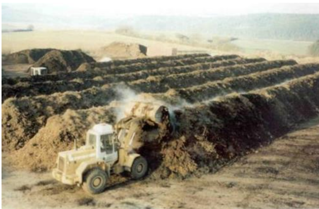
Figura 1 – Compostagem de leiras abertas (extensiva)
