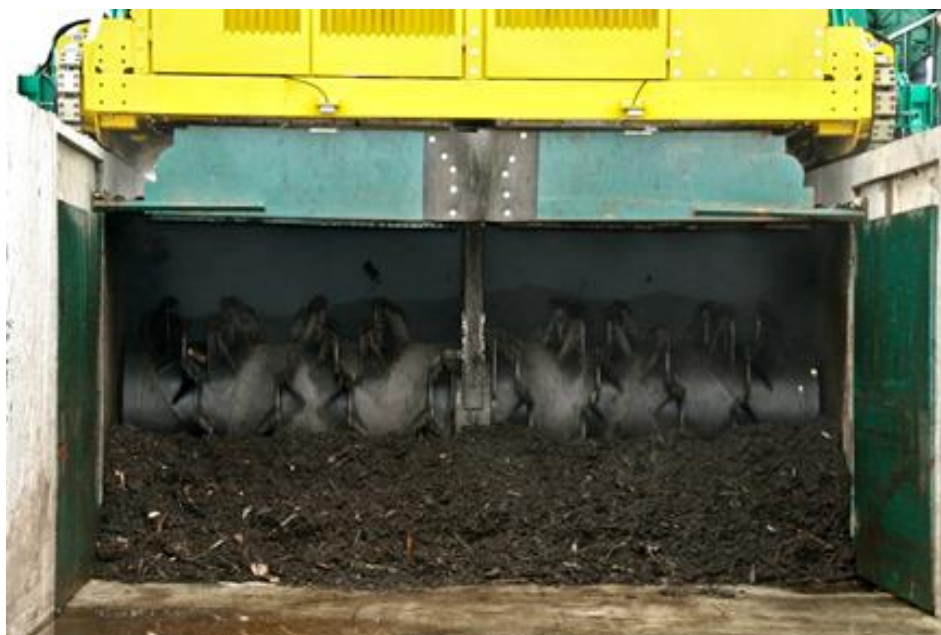
Figura 9 – Sistema de reviramento de linhas ( Lane Turner ) retirada do material
