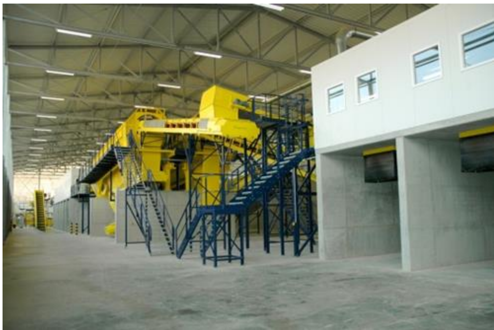
Figura 5 – Peneira rotativa e cabine de triagem manual
