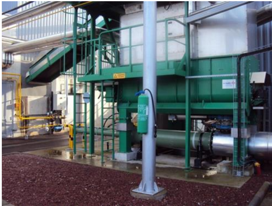
Figura 5 – Misturador para o condicionamento prévio dos orgânicos
