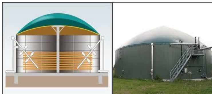
Sistema tipo CSTR Aplicação: resíduos em geral, agrícolas
