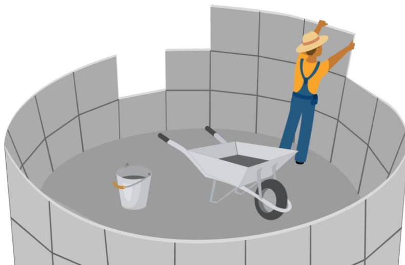
Figura 7: ilustração do assentamento das placas.
