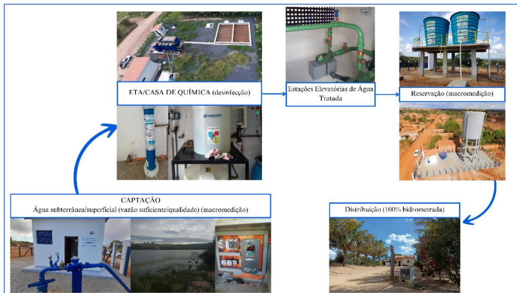
Figura 7. Unidades de sistemas de abastecimento de água depois da filiação com a Central.
