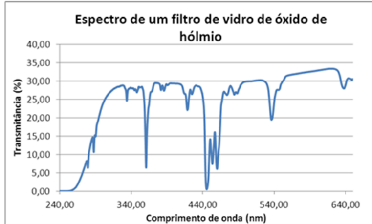
Figura 8 - Espectro de um filtro de vidro de óxido de hólmio com seus picos característicos (Adaptado de "Certified Reference Materials for UV and Visible Spectroscopy"; Optiglass Limited)
