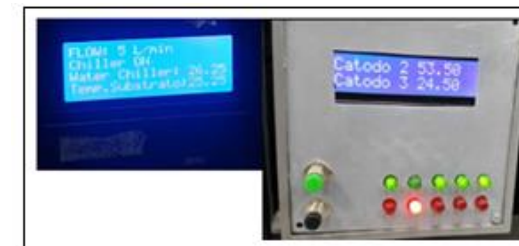
Dataloggers de Temperatura e Vazão
