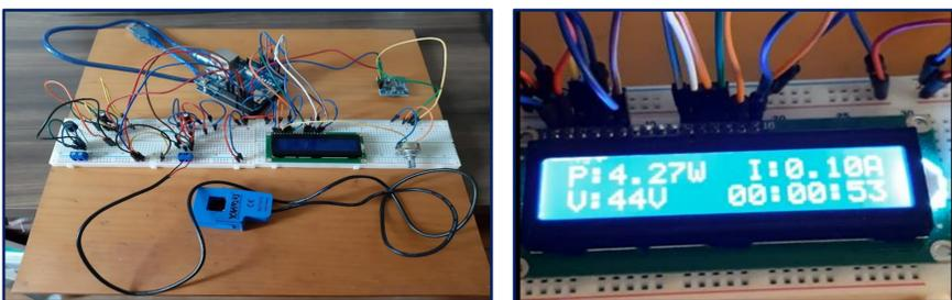
O circuito de calibração do sensor de corrente SCT-013 100A é basicamente um divisor de tensão, necessário para conexão direta com o Arduino Uno e para que o mesmo não apresente variações nas medidas obtidas por longos períodos de análise. O uso do optoacoplador é necessário para isolar e proteger o circuito dos maiores níveis de tensão e flutuações provenientes da rede elétrica (127V / 220V).
