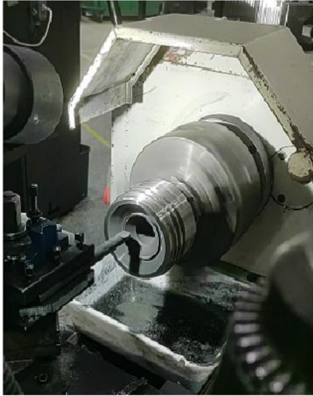
operação de torneamento cônico
