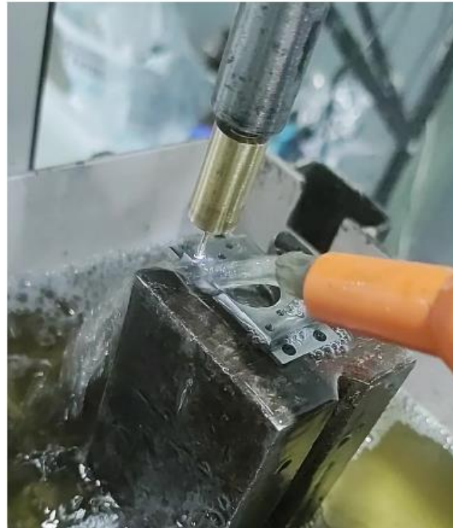
Realização do processo com punção de latão
