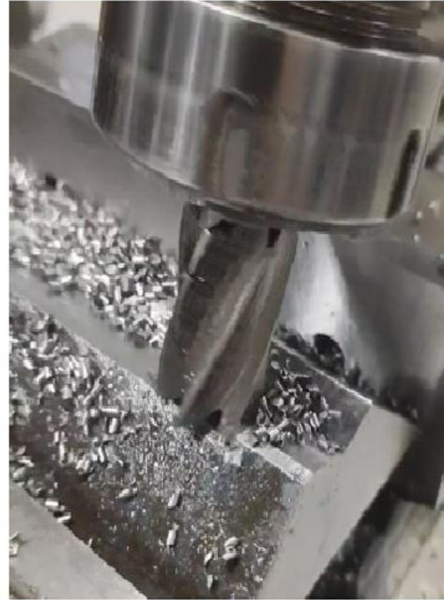
operação de fresamento
