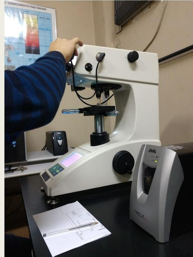
Fig. 17 e 18 Análise de Microdureza em parceria com laboratório LATMAT CEFET com o duromêtro Wolper Wilson Instruments 422MVD carga de 100g por 15s.
