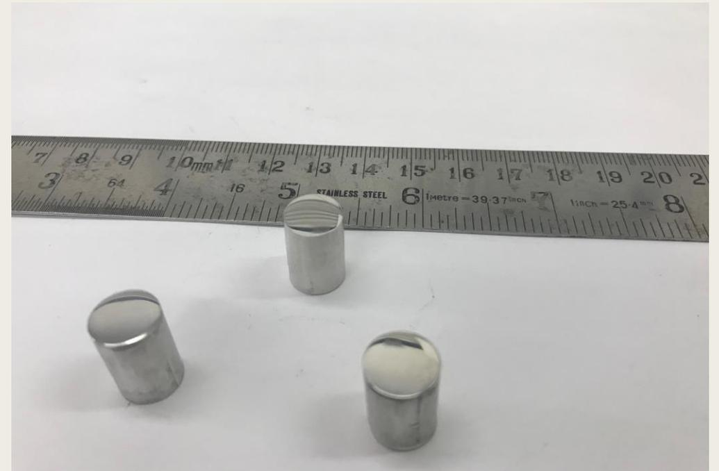
Fig. 14 e 15 corpos de prova lixadas e polidas para análise de microdureza
