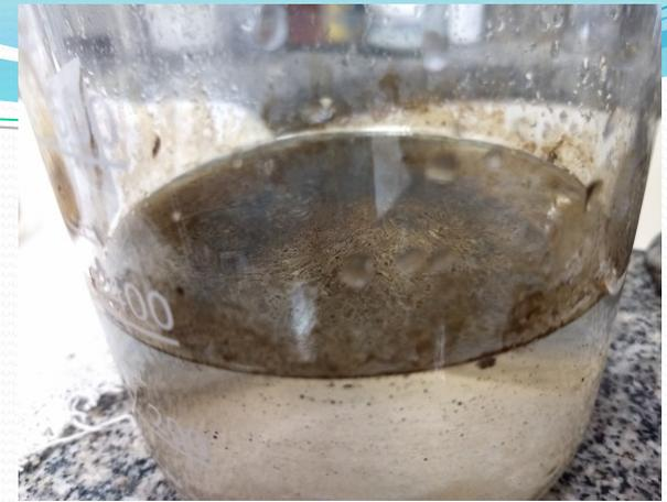
Figura 10: Após retirar a perlita da água - película de óleo ainda presente na superfície da água.
