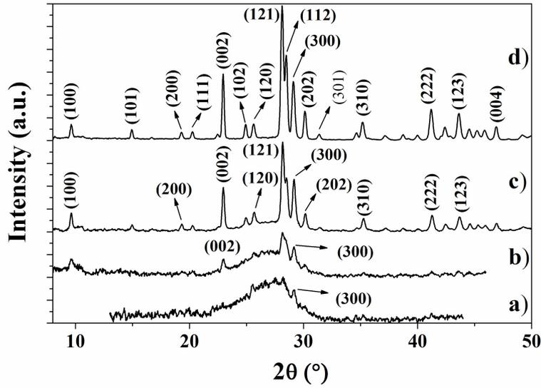
Aumento do filme cristalino de HA ao longo do tempo de deposição à temperatura ambiente. Espessura de a) 90 nm, b) 135 nm, c) 225 nm ed) 540 nm.
