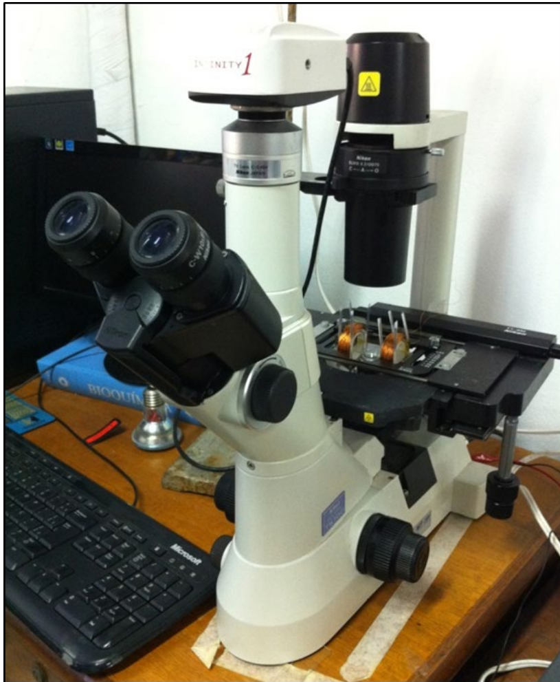
Microscópio invertido Infinity 1 Nikon Eclipse TS100 e par de bobinas associadas a lâmina de amostras dele.
