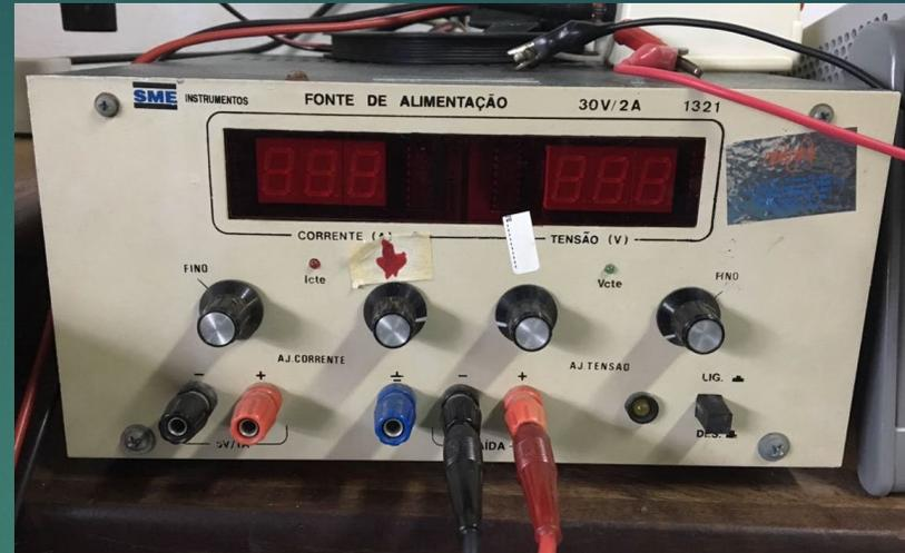
Figura 8: Fonte de alimentação do par de bobinas.
