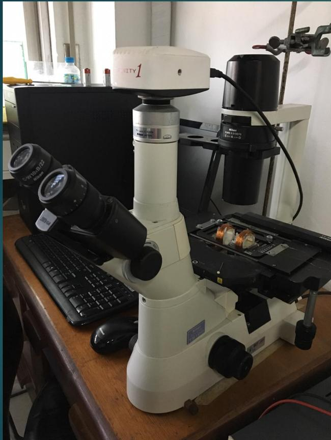
Figura 7: Microscópio invertido com uma câmera acoplada para as filmagens
