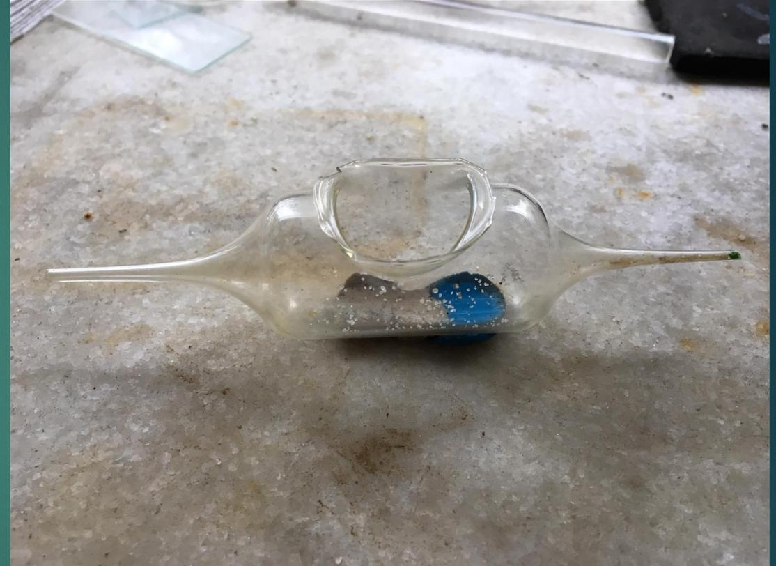
Figura 6: Instrumento concentrador de bactérias magnéticas.
