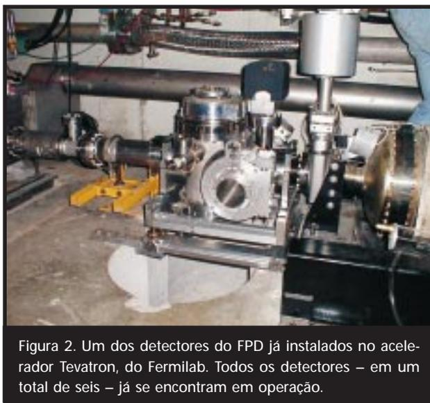
Figura 2. Um dos detectores do FPD já instalados no acelerador Tevatron, do Fermilab. Todos os detectores – em um total de seis – já se encontram em operação.
