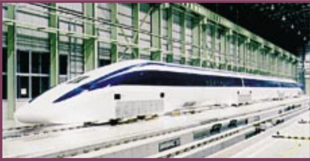
Figura 4. Trem que emprega o princípio da levitação magnética.
