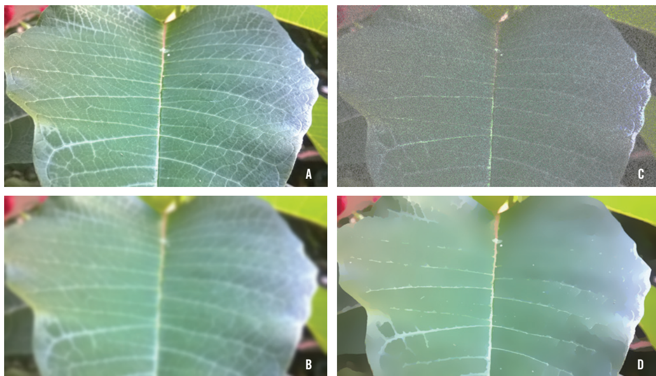
Figura 4. Aplicações das difusões direta (B), reversa (C) e não-linear (D) sobre a imagem de uma folha (A). O colapso da imagem (C) é evidente, diferentemente de (D), em que os principais contornos foram mantidos ou realçados
