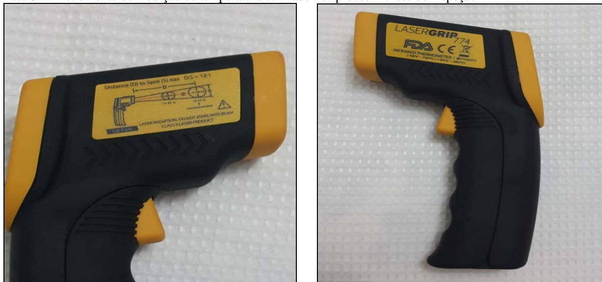
Foto 32 - Instrumento de medição de temperatura utilizado nos procedimentos de inspeção
