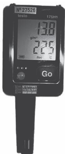
Figura 4 – Termogrômetro digital.
