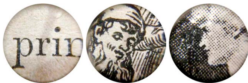
Fig. 8 Registro fotográfico microscópico de processos de impressão com matrizes em relevo, compatíveis entre si: tipografia e xilogravura de topo (ou copia em clichê) ambas de Contos Seletos das Mil e Uma Noites (Laemmert, 1882, BN), e clichê por
