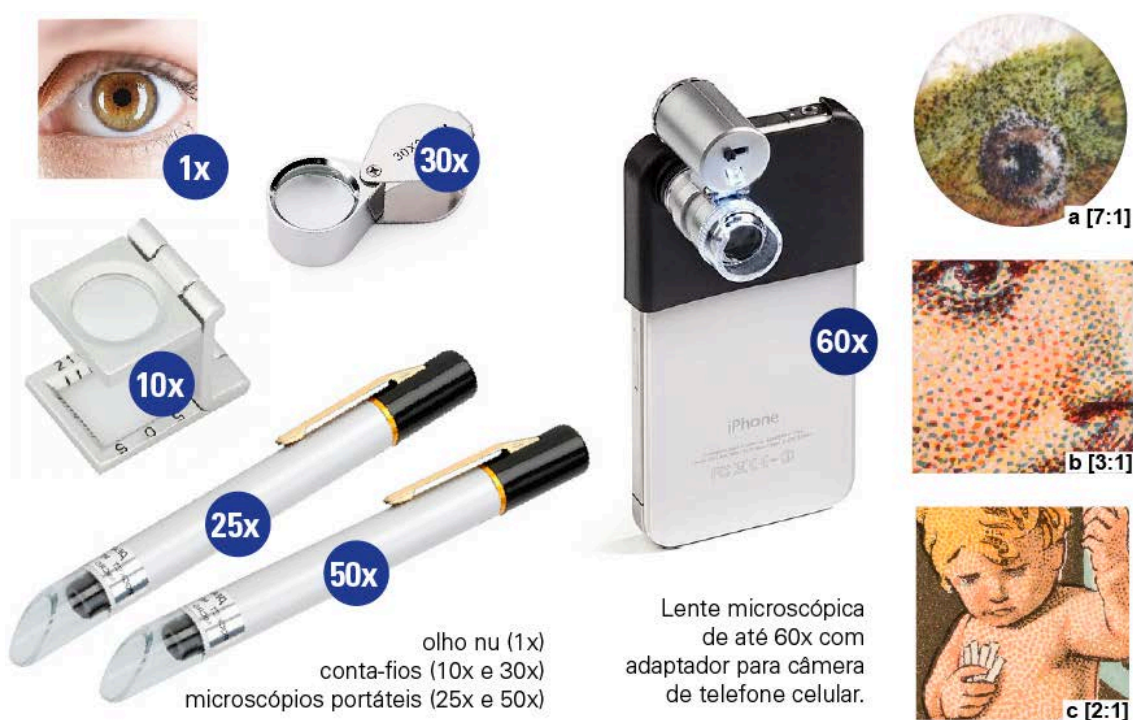
Fig. 1 Dispositivos de análise e registro microscópico das fontes primarias da metodologia proposta por Barros, 2018, evidenciando as técnicas gráficas empregadas.
