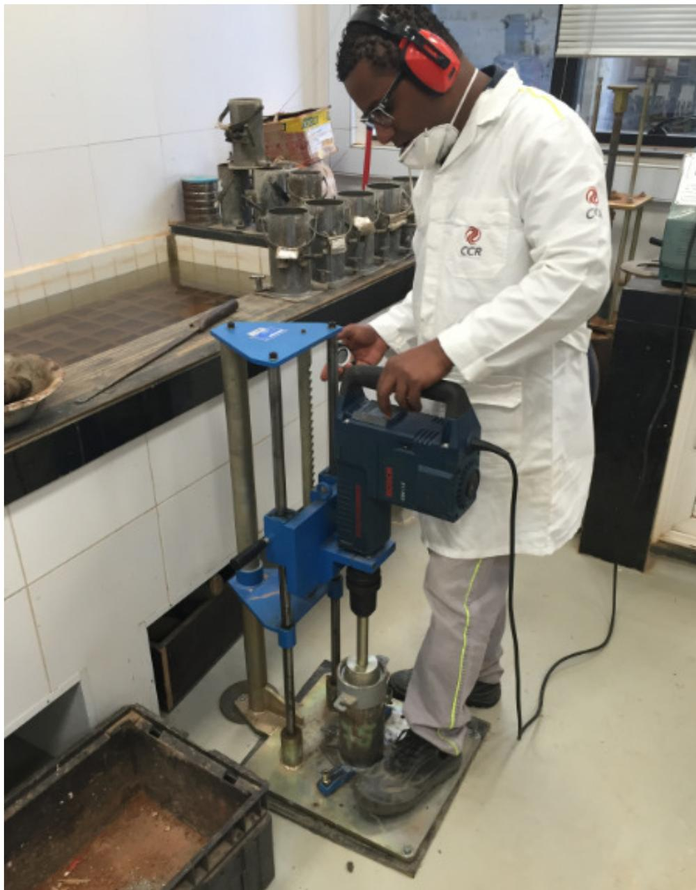
Figura 2.1: Compactador vibratório utilizado para a moldagem dos corpos de prova de BGTC
