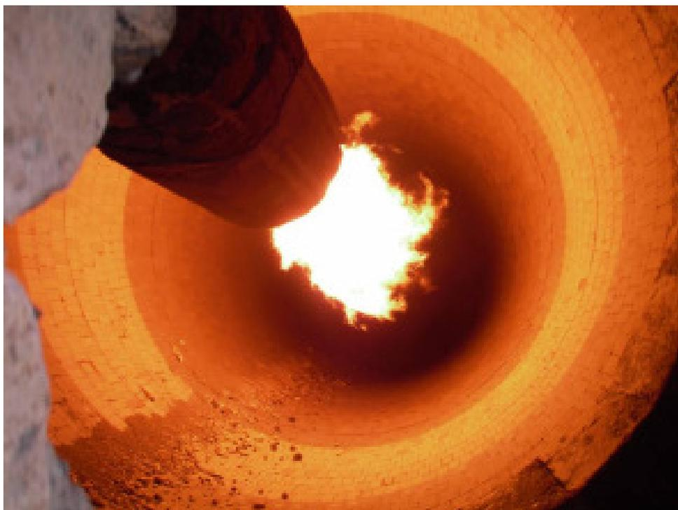
Figura 3.2: Forno giratório para produção de clínquer. FONTE: [www.cimento.org](http://www.cimento.org)
