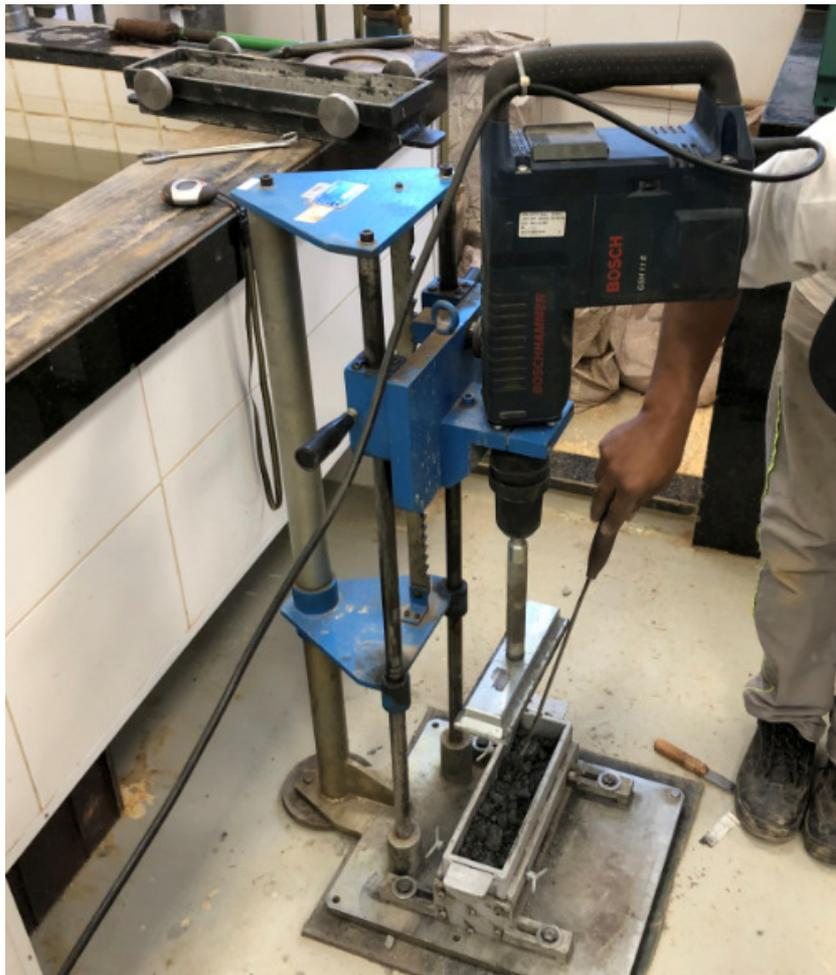
Figura 2.3: Compactação de CPs para ensaio expansão/retração
