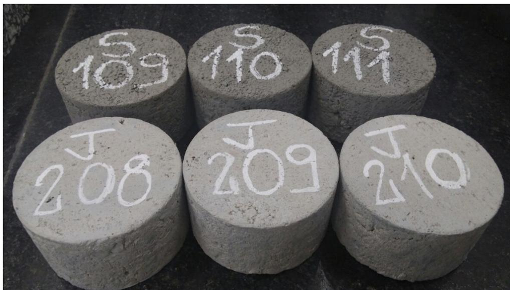
Figura 6.12: Corpos de prova para execução do ensaio de resistência à tração por compressão diametral
