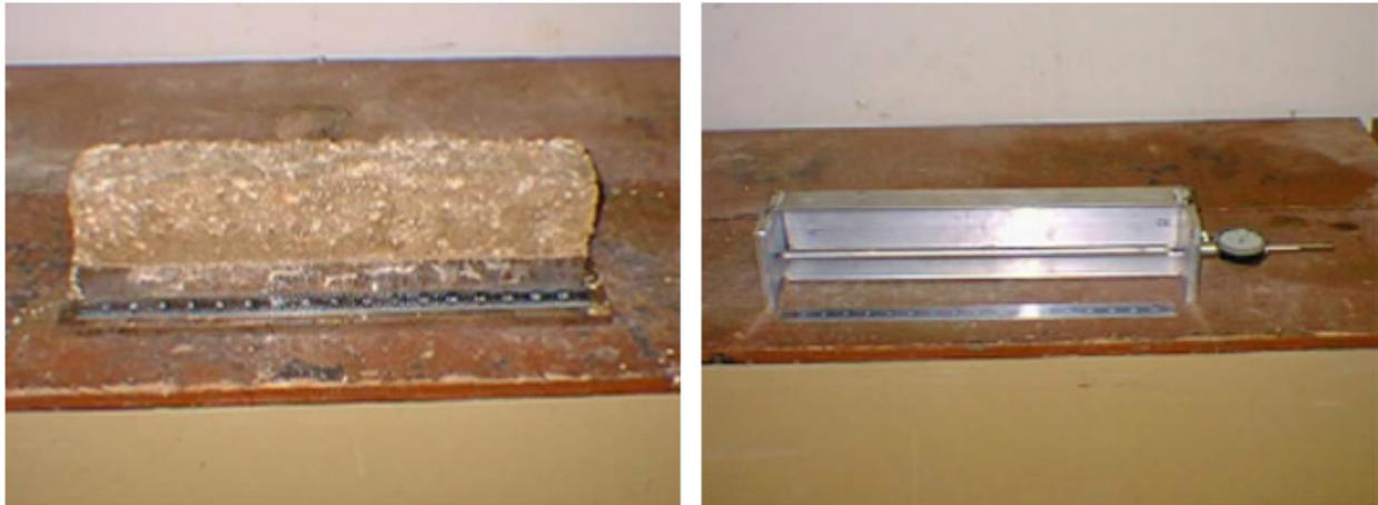
a) Corpo de prova prismático
