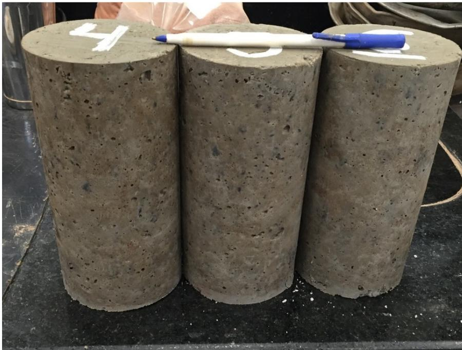
Figura 6.1: Corpos de prova para o ensaio de compressão simples, moldados no compactador vibratório em quatro camadas
