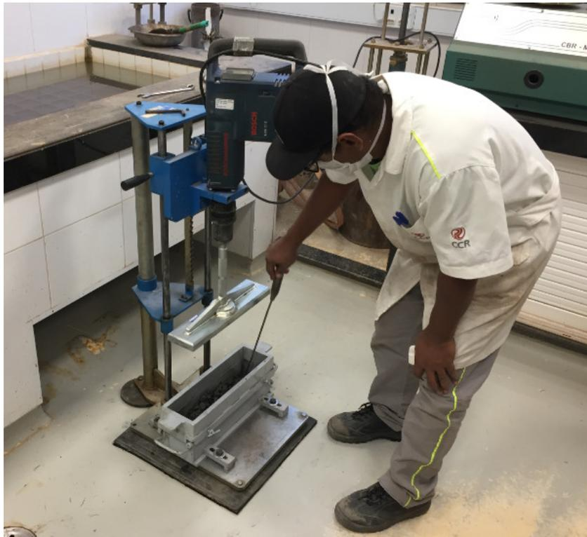
Figura 2.2: Compactação de CPs para ensaio de tração na flexão
