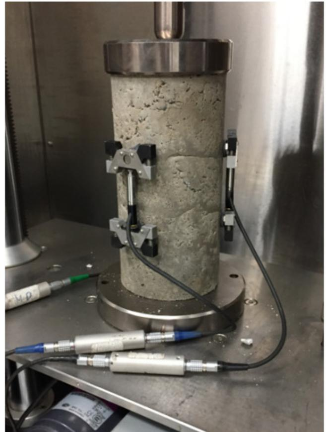
b) Detalhe dos LVDTs
