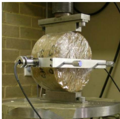
Figura 3.15: Ensaio de compressão diametral. FONTE: Yeo (2008)
