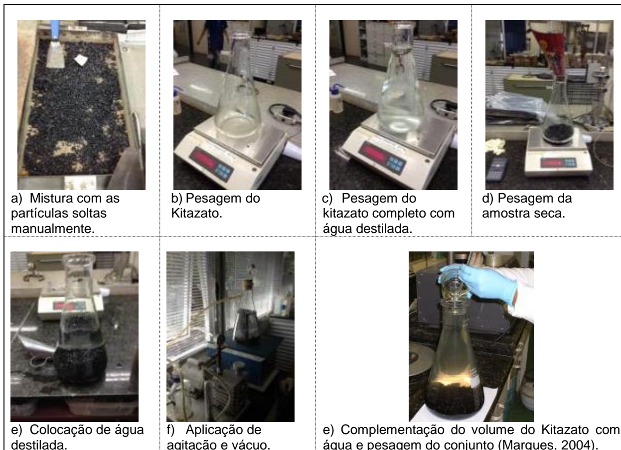
Figura 3.9 – Algumas etapas do procedimento do ensaio RICE para determinação da Gmm
