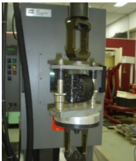
Figura 3.21 – Exemplo de execução de ensaio de R_t em amostras cilíndricas de concreto asfáltico
