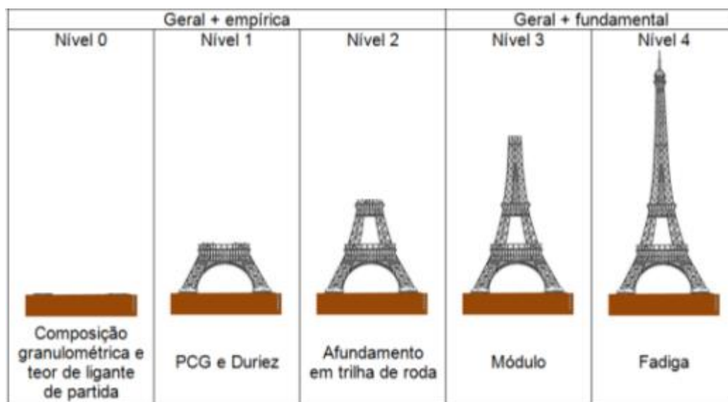
Figura 2.3 – Desenho esquemático da relação entre os níveis de projeto de misturas asfálticas do método francês e os respectivos ensaios (adaptado de LCPC, 2007)
