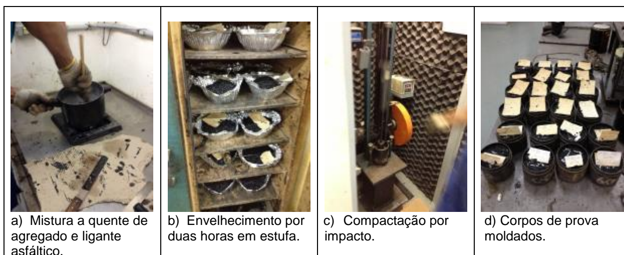
Figura 3.10 – Algumas etapas do procedimento de dosagem Marshall
