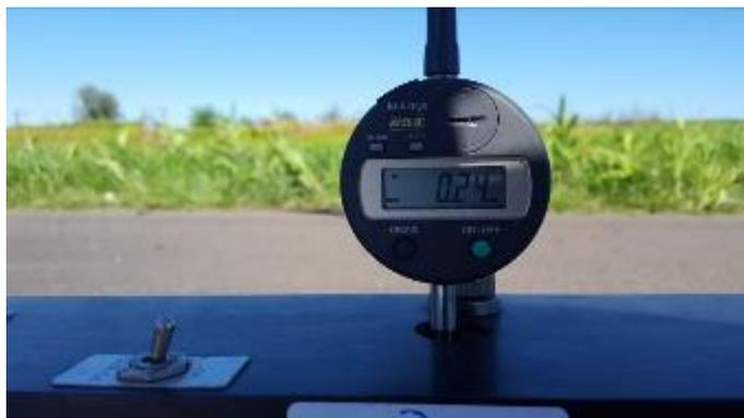
Foto 40- Vista do início do ensaio com leitura inicial zero no defletômetro digital.
