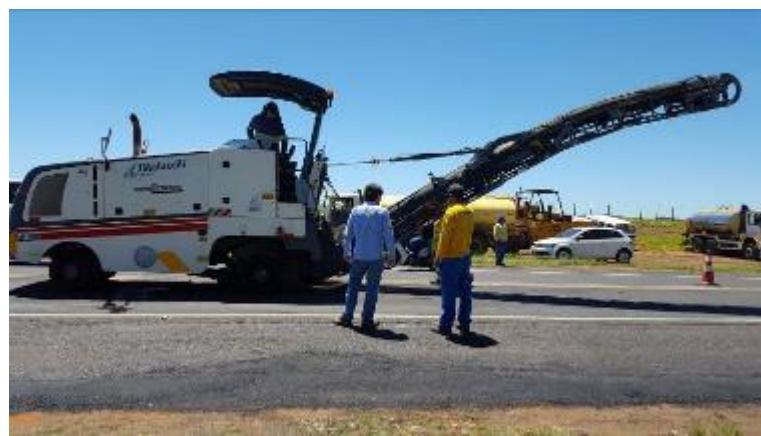
Foto 53- Vista da fresadora utilizada nos serviços de fresagem do revestimento primitivo.
