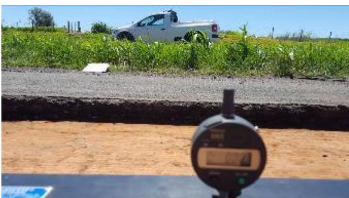
Foto 46- Vista do início do ensaio com leitura inicial zero no defletômetro digital.
