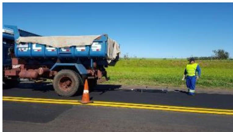
Foto 48- Vista do levantamento de deflexões reversíveis no revestimento asfáltico executado sobre a base de solo-cimento.
