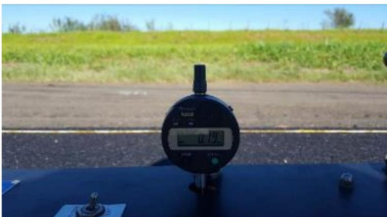
Foto 51- Vista do final do ensaio com leitura final 19 (0.01mm) no defletômetro digital.
