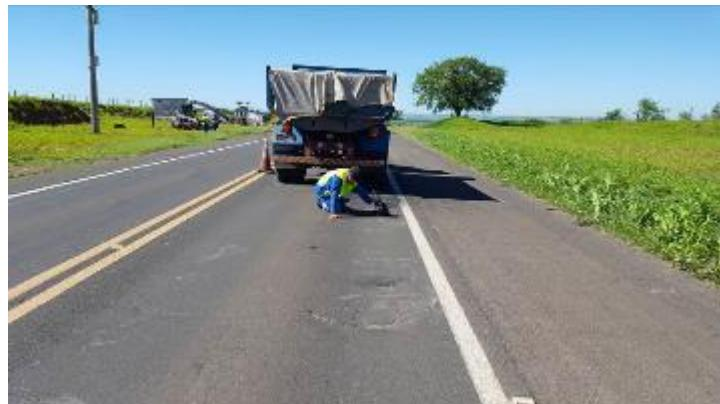
Foto 37- Vista do levantamento de deflexões reversíveis no revestimento primitivo.
