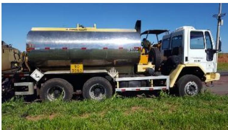
Foto 78- Vista do caminhão espargidor utilizado na aplicação da pintura de ligação no subtrechos 2.
