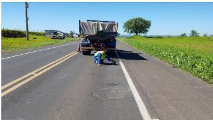
Foto 37- Vista do levantamento de deflexões reversíveis no revestimento primitivo.
