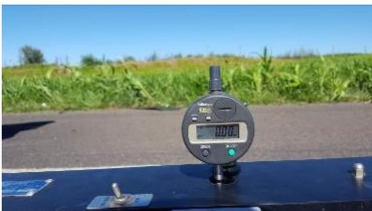
Foto 39- Vista do início do ensaio com leitura inicial zero no defletômetro digital.
