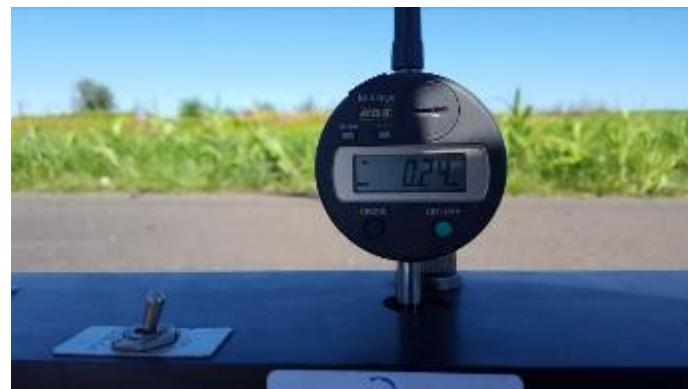
Foto 40- Vista do início do ensaio com leitura inicial zero no defletômetro digital.
