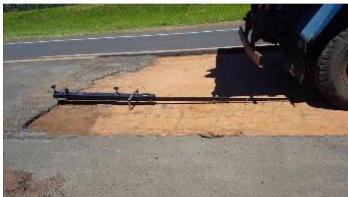
Foto 43- Vista do levantamento de deflexões reversíveis na base de solo-cimento na distância de 2m. Notar que não foi possível nivelar a viga Benkelman.
