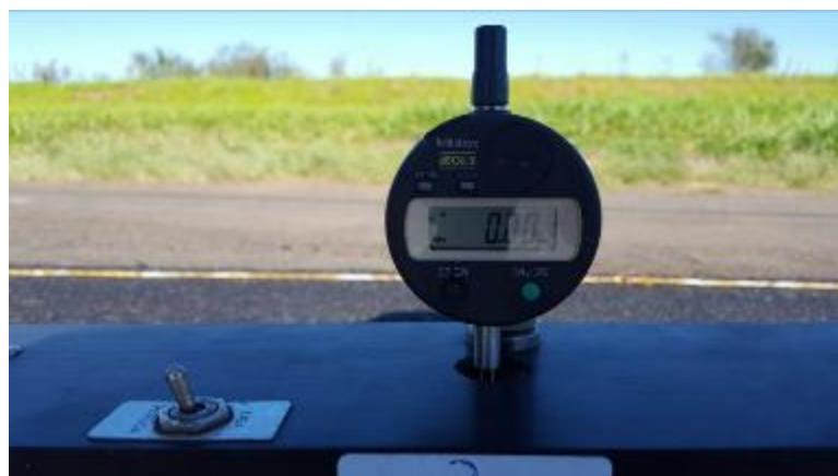
Foto 50- Vista do início do ensaio com leitura inicial zero no defletômetro digital.
