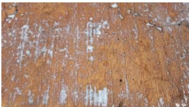
Foto 65- Vista do produto "DUROCK" antes da evaporação da água sobre a base de solo-cimento.
