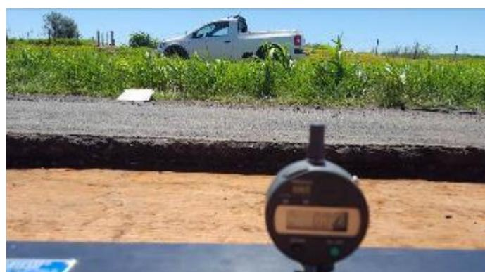
Foto 46- Vista do início do ensaio com leitura inicial zero no deflectômetro digital.
