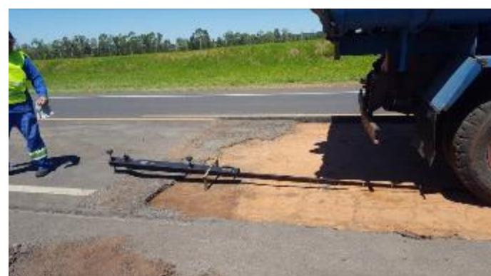
Foto 42- Vista do levantamento de deflexões reversíveis na base de solo-cimento na distância de 2m. Notar que não foi possível nivelar a viga Benkelman.
