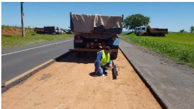
Foto 45- Vista do levantamento de deflexões reversíveis na base de solo-cimento.
