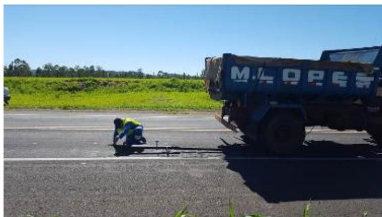
Foto 38- Vista do levantamento de deflexões reversíveis no revestimento primitivo.
