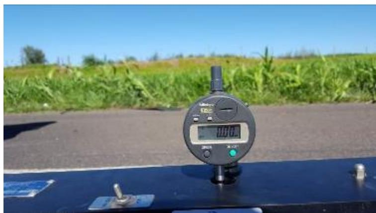
Foto 39- Vista do início do ensaio com leitura inicial zero no deflectômetro digital.
