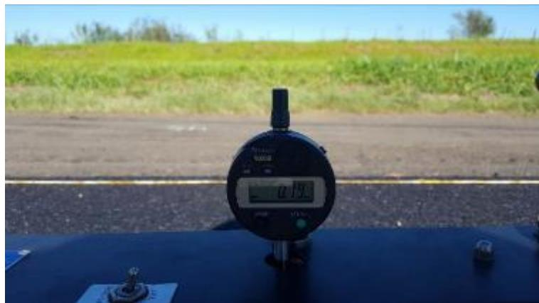
Foto 51- Vista do final do ensaio com leitura final 19 (0.01mm) no defletômetro digital.
