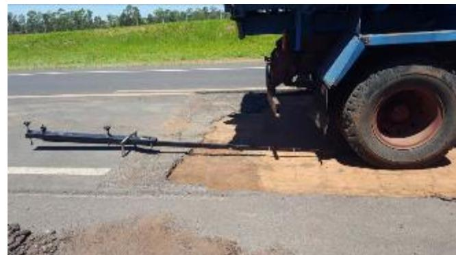
Foto 41- Vista do levantamento de deflexões reversíveis na base de solo-cimento na distância de 1m. Notar que não foi possível nivelar a viga Benkelman.
