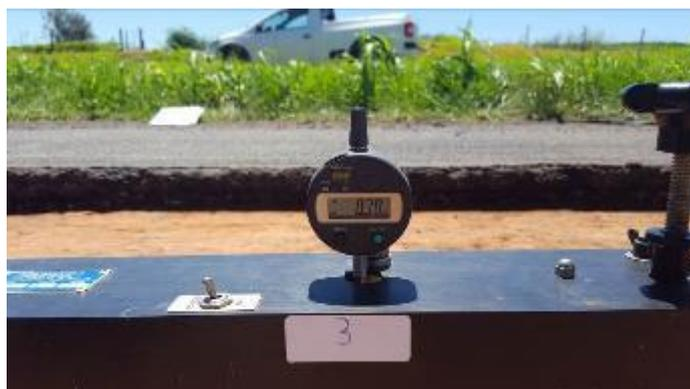
Foto 47- Vista do final do ensaio com leitura final 30 (0.01mm) no defletômetro digital.
