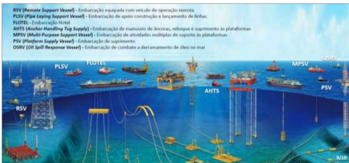
Figura 04 - Algumas embarcações utilizadas no apoio marítimo.
