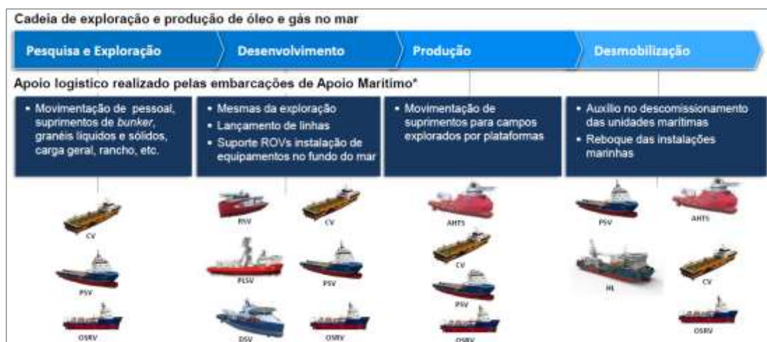
Figura 03 - Etapas da exploração offshore de P&G e tipos de embarcações utilizadas.
