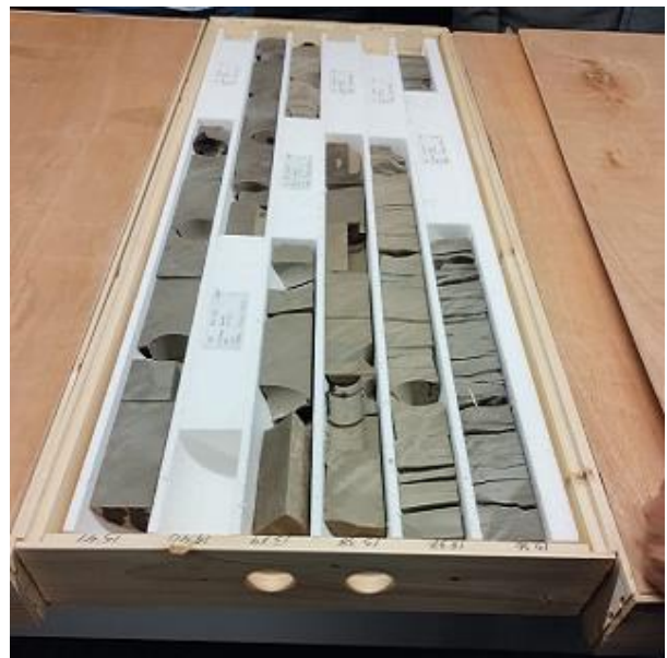
Caixa de testemunho na bancada.
