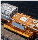
SSAO     | 1          | Instalado em Marlim. Vazão = 3.500 m <sup>3</sup> /d, BSW = >70%, Eficiência de Separação = 85%.                                       | Alto BSW, falta de capacidade para tratamento de água na plataforma, campos maduros. |
