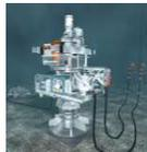
VASPS    | 1          | Instalado em Marimbá. Vazão = 2.000 a 3.000 m <sup>3</sup> /d, GFV = 90%, Eficiência de Separação = acima de 99%                       | Alto RGO, aumento da vazão de produção.                                              |
