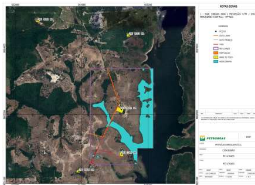
Duto de coleta 3" – poço 1-RJ-01-BA
