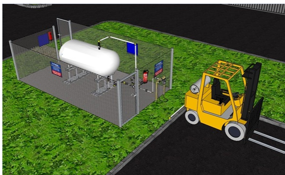
Figura 18 - Centrais para transferência de GLP para recipientes montados empilhadeiras
