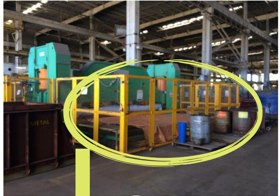
Equipamento com o devido guarda corpo para proteção anti quedas e restringindo o acesso conforme NR-12
