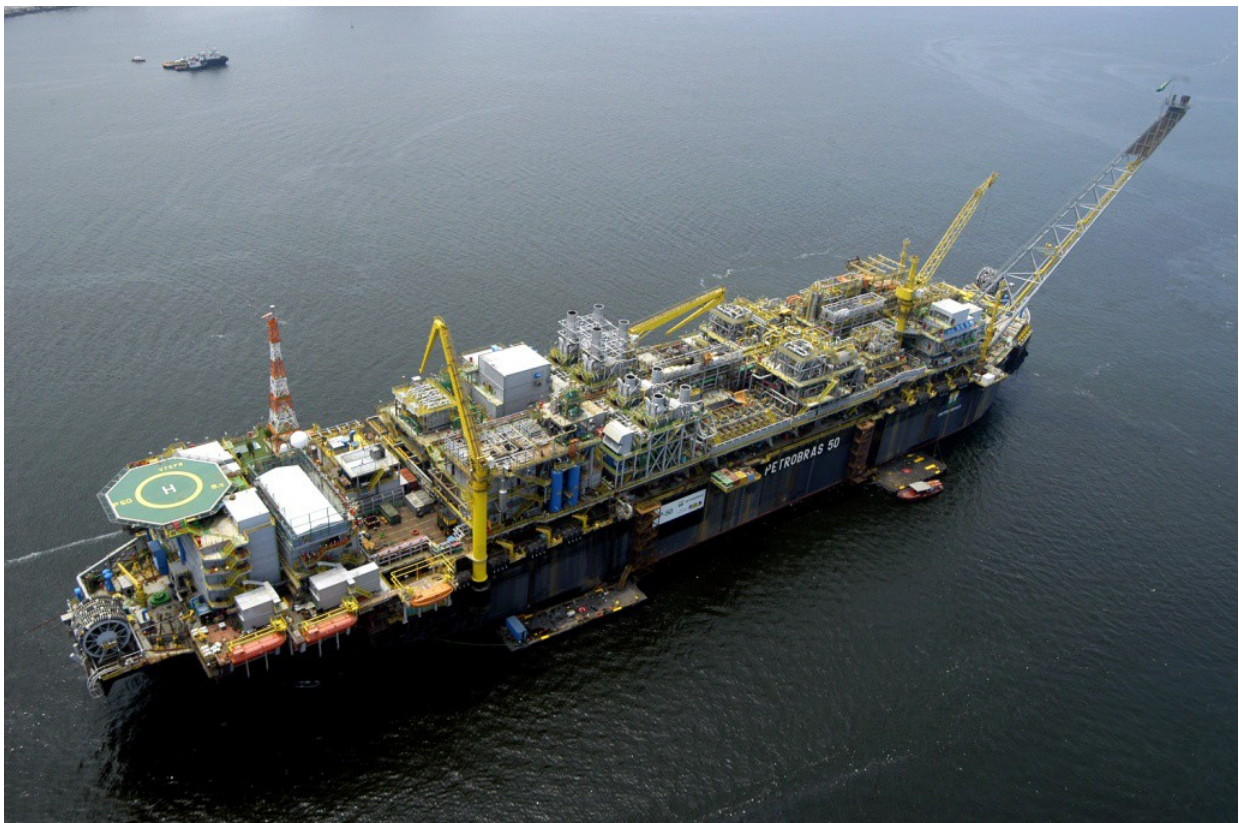
Figura 10 – FPSO P-50 – Após saída do cais 1 do Estaleiro Mauá para finalização Comissionamento em fundeio
