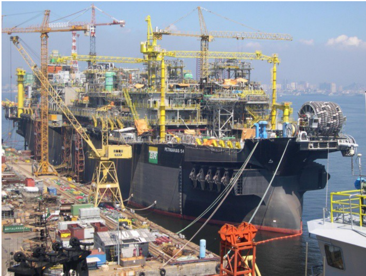
Figura 13 – FPSO P-54 – Atracado no cais 1 do Estaleiro Mauá durante Integração e Comissionamento
