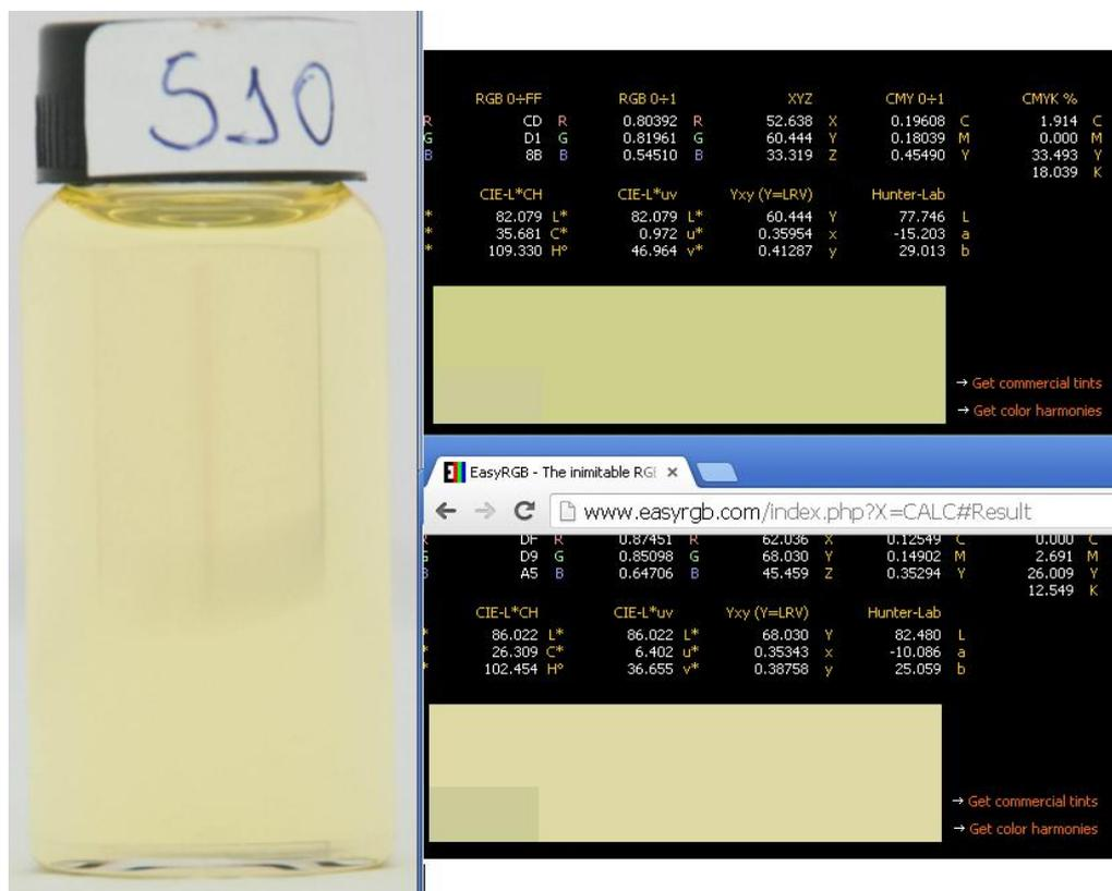
**Figura 7.** Análise comparativa do: padrão de óleo Diesel S10 (esquerda), cor obtida nos ensaios 1/2 (direita-cima), cor obtida no ensaio 3 (direita-baixo).
