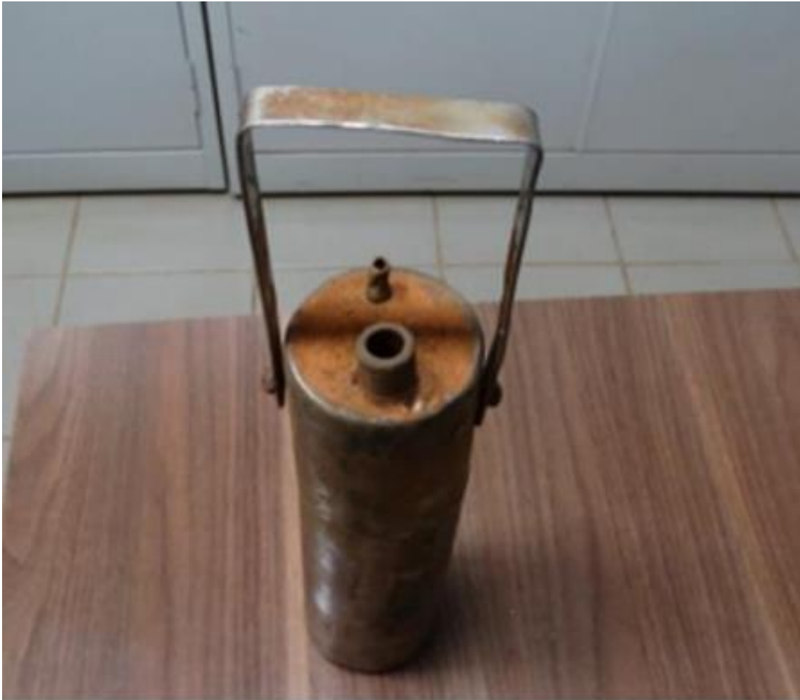
Figura 16 – Amostrador encontrado dentro do tanque.
