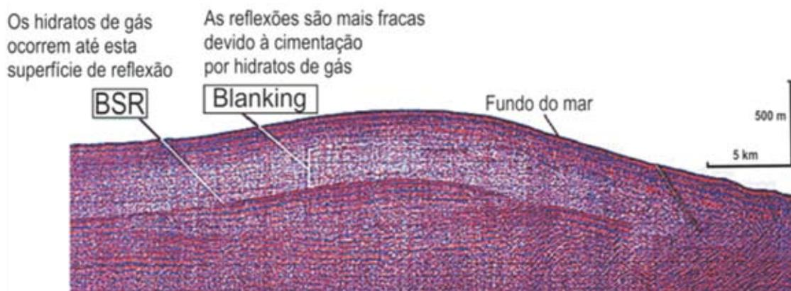
Figura 6.7 – Perfil sísmico com indicações de acumulações de hidratos de gás. Adaptado de <http://woodshole.er.usgs.gov/project-pages/hydrates/index.html>
