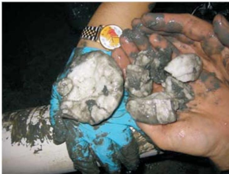
Figura 3.16. Amostra de hidrato de gás coletada no Canyon do Mississippi, Golfo do México. Fonte: <http://soundwaves.usgs.gov/2002/09>
