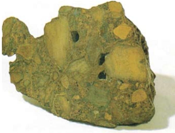
Figura 3.14 – Amostra de fosforita com teor de 15-18% de  $P_2O_5$ , coletada na plataforma continental do Marrocos, apresenta dimensão máxima de 12 cm. Fonte: Summerhays, 1998.
