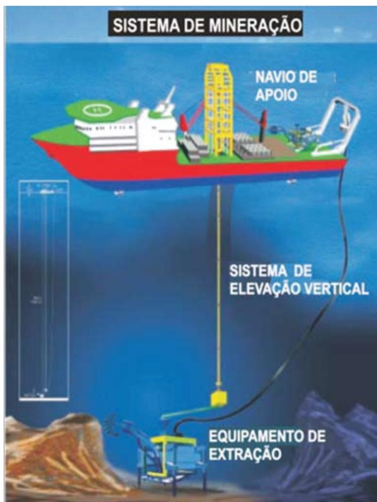
Figura 6.11 – Diagrama esquemático do sistema de mineração de sulfetos de mar profundo que está sendo desenvolvido pela Nautilus Minerals Inc. Adaptado de Heydon & Scott (2008).
