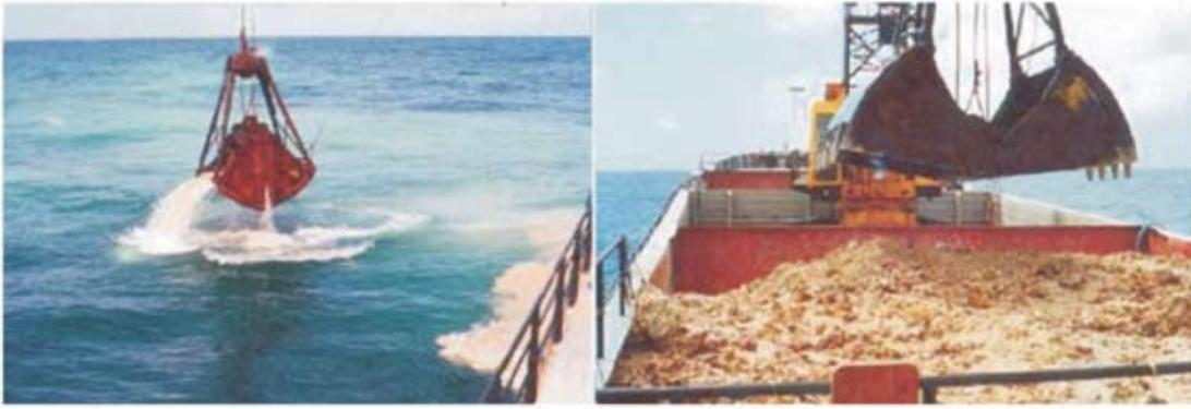
Figura 6.2 – Draga de caçamba (*clam-shell*) em operação. Fonte: Algarea Mineração, 2005.
