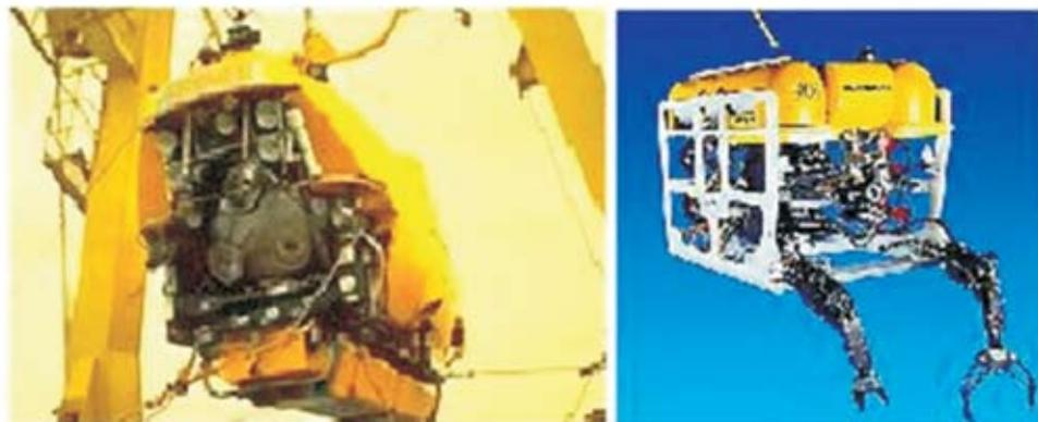
Figura 6.6 – Submersível *Nautilus* desenvolvido pelo IFREMER (*Institut Français de Recherche pour l'Exploitation de la Mer*) e Veículo de Operação Remota (ROV).
