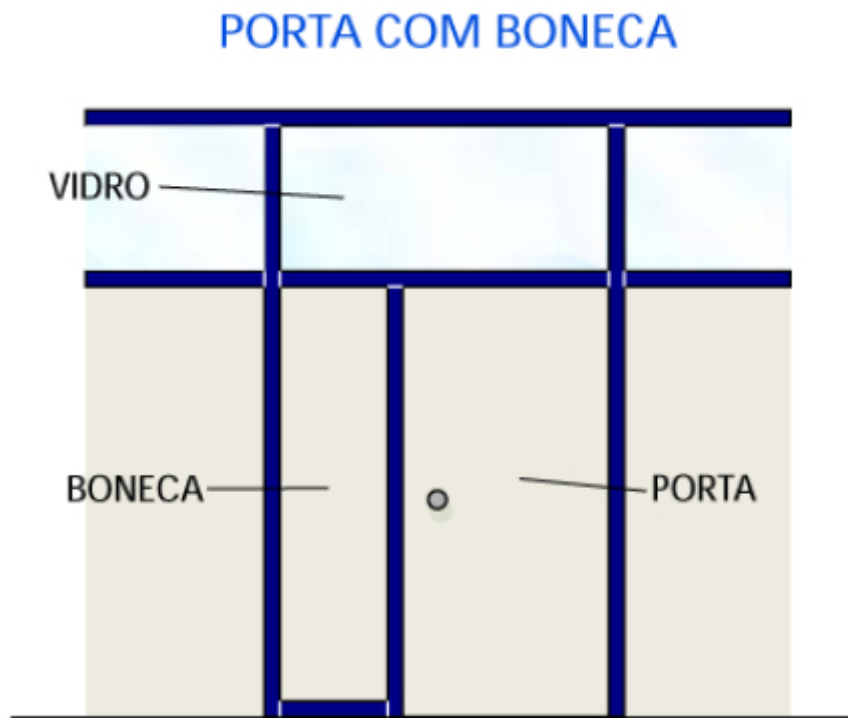
Figura 11 - Porta instalada com a colocação de boneca
