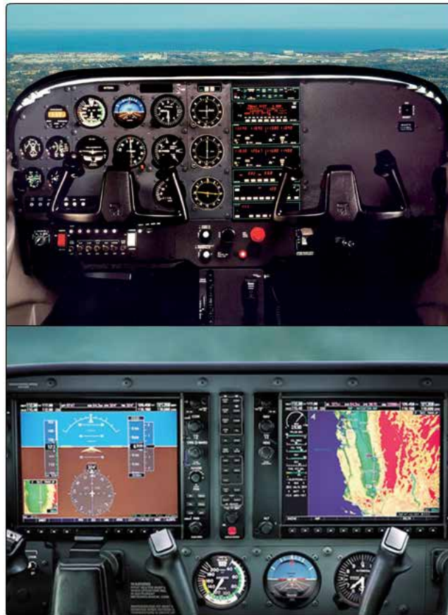
Figura 18. Tela analógica (em cima) e tela digital (embaixo) de um Cessna 172.
