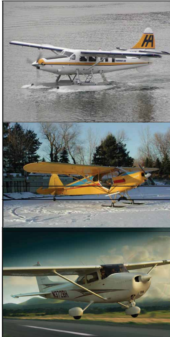
Figura 12. Tipos de trem de pouso: flutuadores (em cima), esquis (no meio) e rodas (embaixo).
