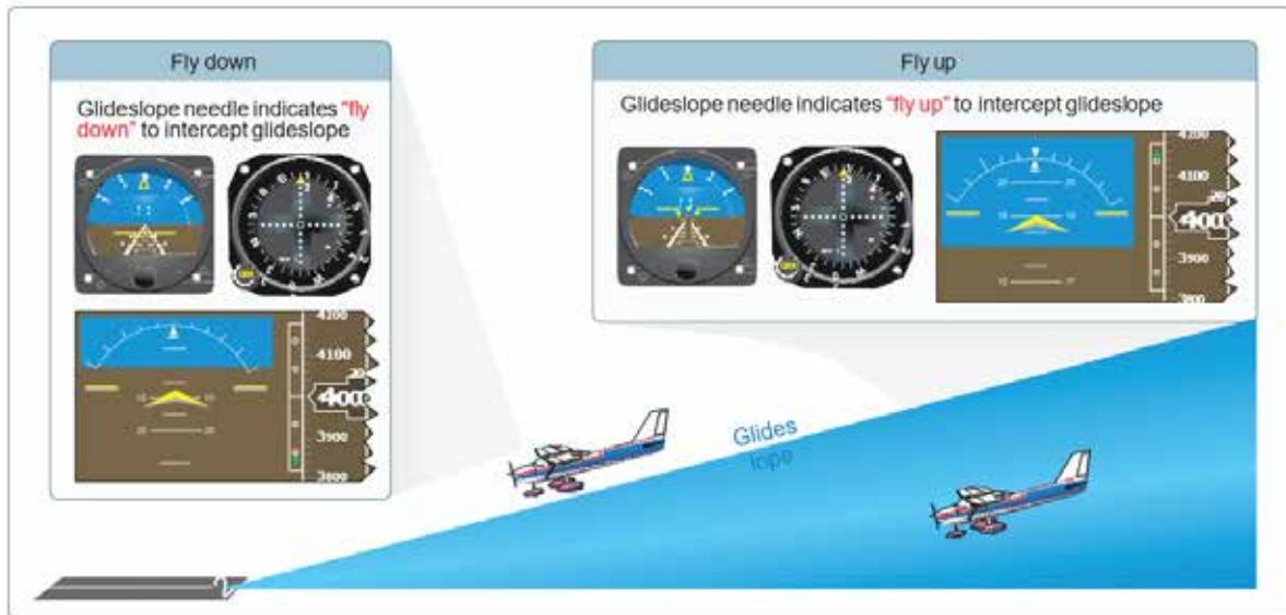
Figura 22. Indicações analógicas e digitais para interceptação de glideslope .
