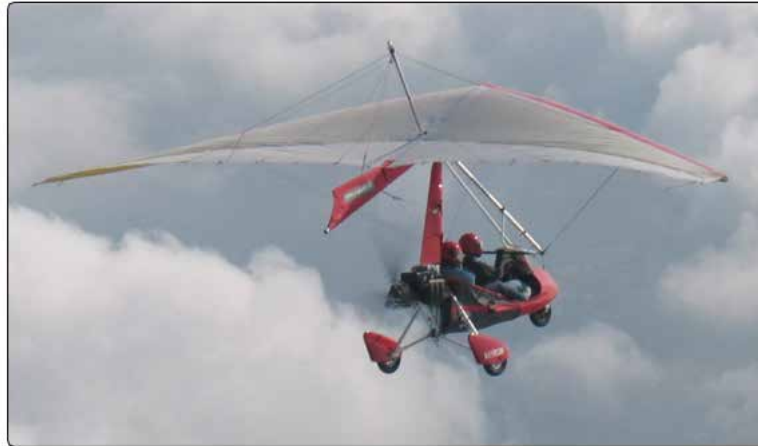
Figura 9. Aeronave aerodesportiva que usa o deslocamento de peso para controle.
