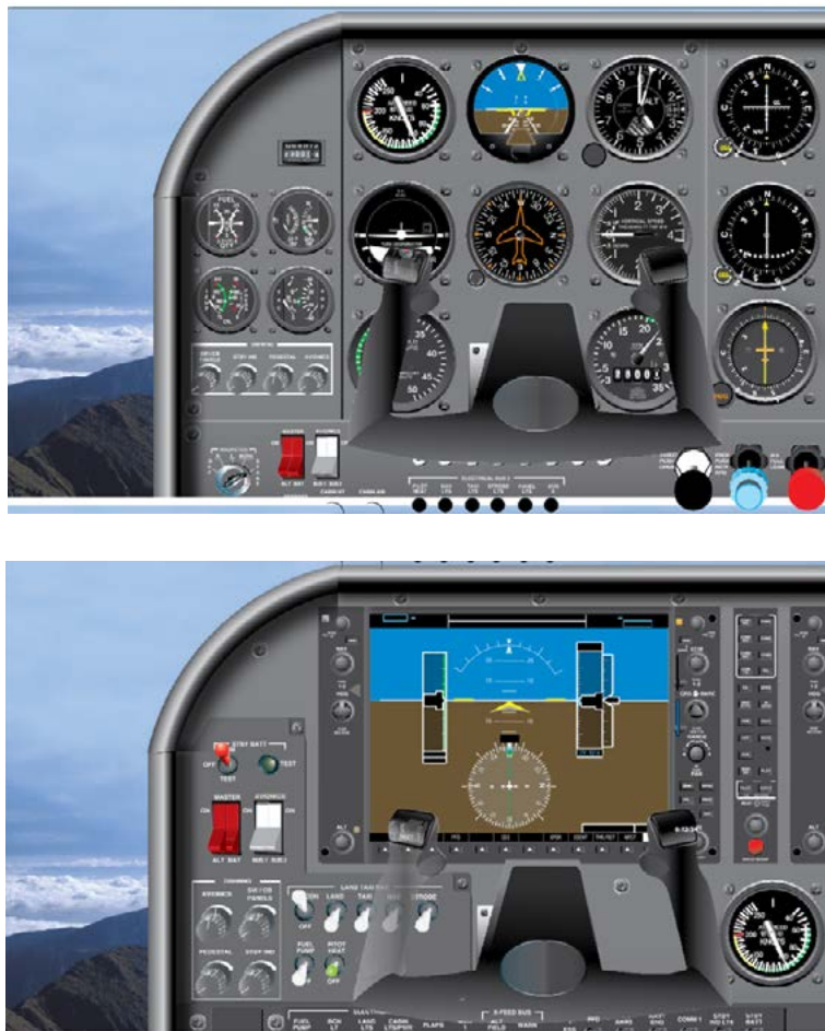
Figura 22. Duas cabines de comando semelhantes equipadas com as mesmas informações de duas maneiras diferentes, analógica e digital. O que elas estão indicando? É provável que o piloto analógico revise a tela superior antes da tela inferior. Por outro lado, o piloto treinado digitalmente analisará o painel de instrumentos na parte inferior primeiro.
