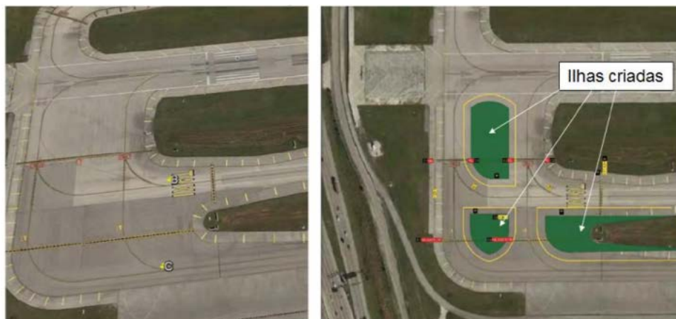
Figura D.3 – Criação de ilhas em pistas de táxi com grandes áreas pavimentadas.
