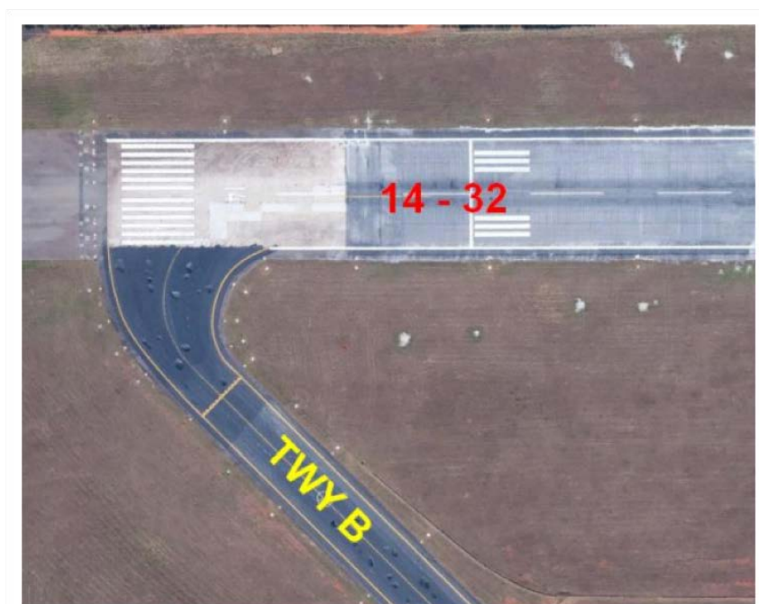
Figura D.1 – Pista de taxi de acesso não permite visualização de toda a PPD
