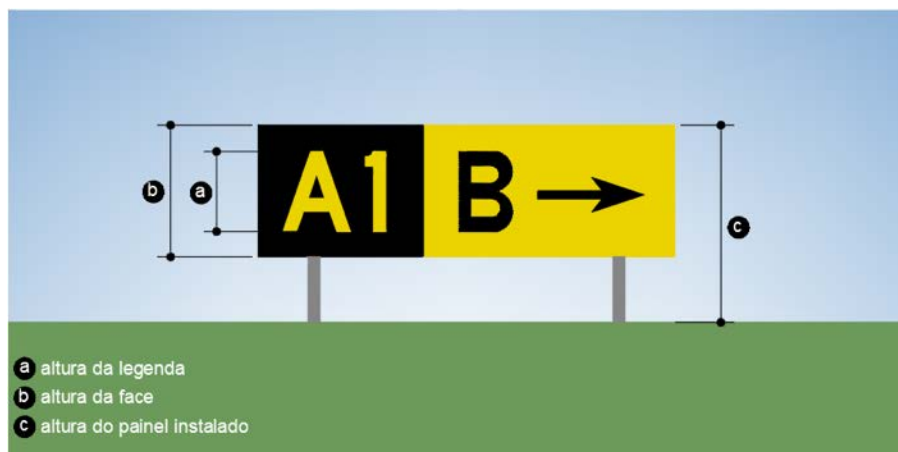
Figura 38. Altura da legenda, da face e da instalação das placas de sinalização vertical.
