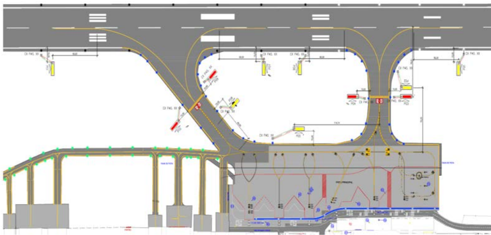
Figura 42. Desenho "as built" com indicação da localização (incluindo cotas) e disposição das sinalizações verticais.
