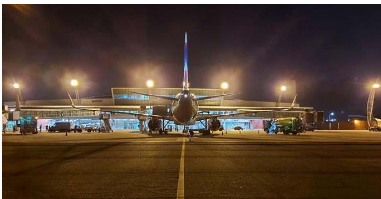
Figura 32. Iluminação da posição de estacionamento.
