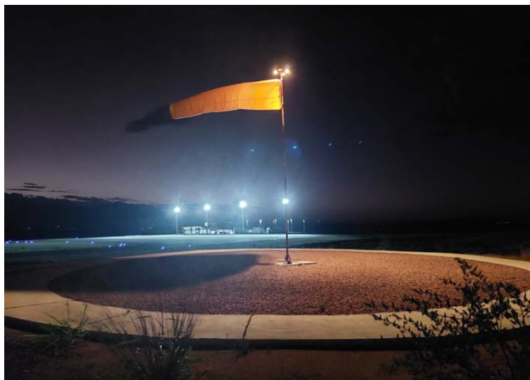
Figura 45. Imagem noturna do indicador de direção de vento iluminado.
