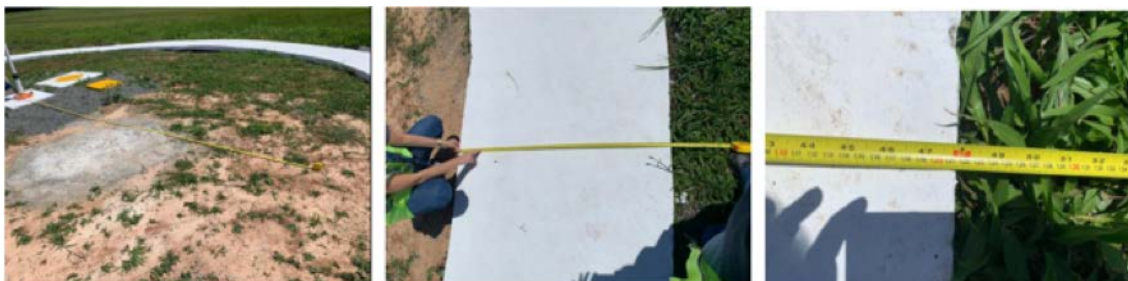
Figura 44. Medições do diâmetro e da largura da faixa circular do indicador de direção de vento.
