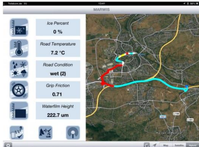
Sensor móvel para medições de condições de pista e clima
