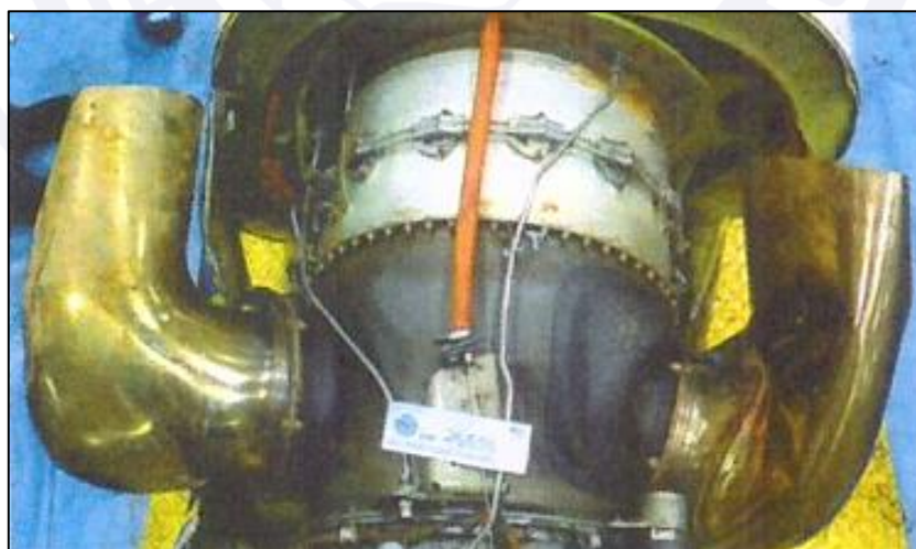
Figura 35 - Detalhe das deformações da parte inferior do duto de escape do motor direito.
