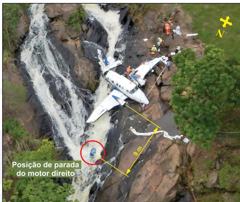
Figura 18 - Identificação do local de parada do motor/hélice direitos.
