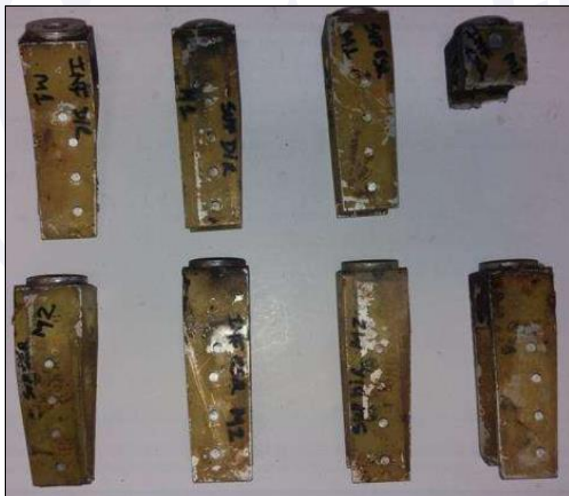
Figura 43 - Suportes de fixação dos motores esquerdo (acima) e direito (abaixo).
