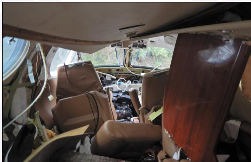
Figura 22 - Extensão dos danos no interior da aeronave.
