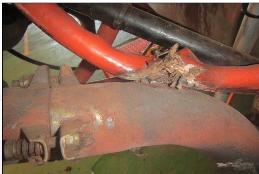
Figura 2 - Cabeamento elétrico do motor danificado e encostado no escapamento.
