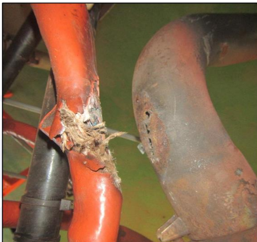
Figura 4 - Danos gerados no cabeamento elétrico e no escapamento.
