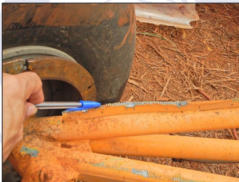
Figura 3 - Estrutura do trem de pouso cisalhada pelo contato com o cabo de aço.
