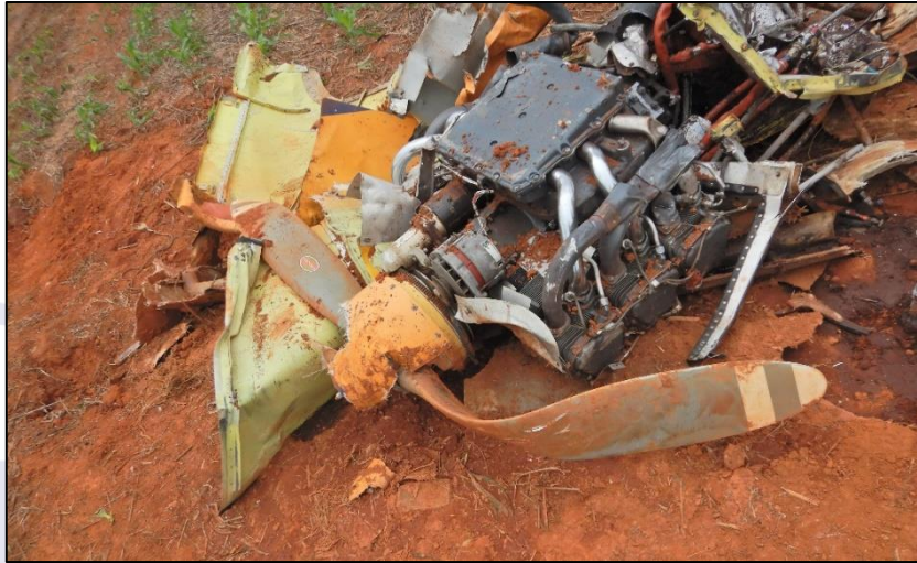
Figura 4 - Hélice com indícios de potência disponível.
