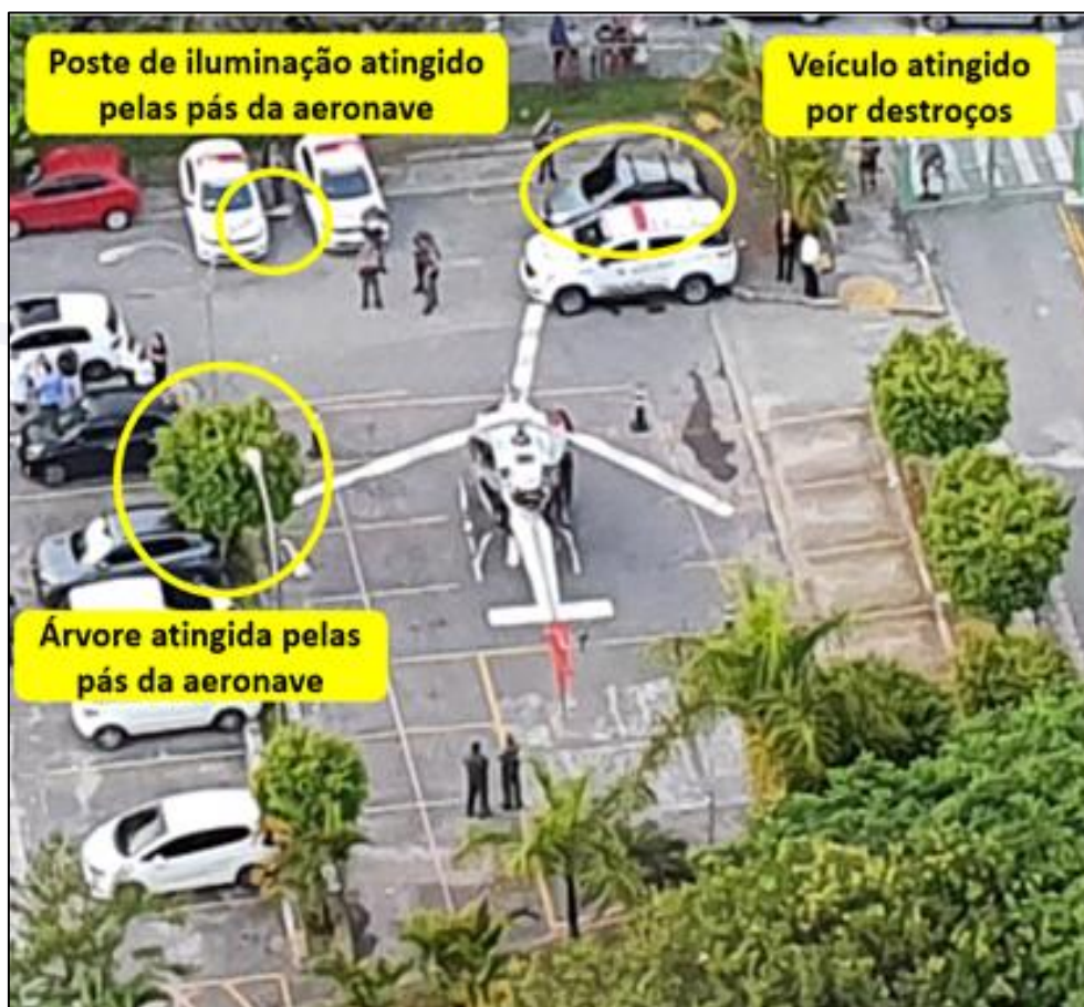
Figura 4 - Local do acidente e objetos atingidos pela aeronave e seus destroços.
