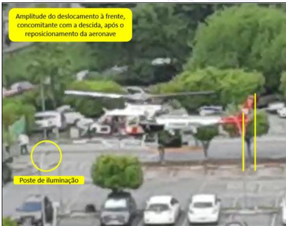
Figura 8 - Momento seguinte à imagem anterior, referenciando o deslocamento à frente, em relação ao terreno. Fonte: Imagem captada de vídeo cedido por observador do acidente.
