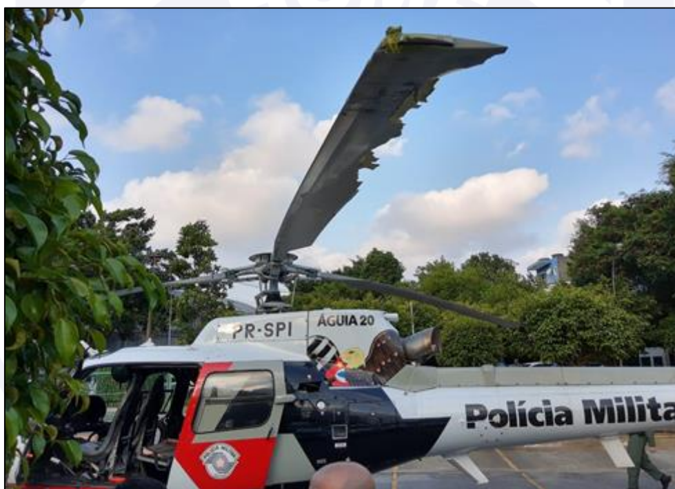
Figura 1 - Vista dos danos ao PR-SPI no local do acidente.
