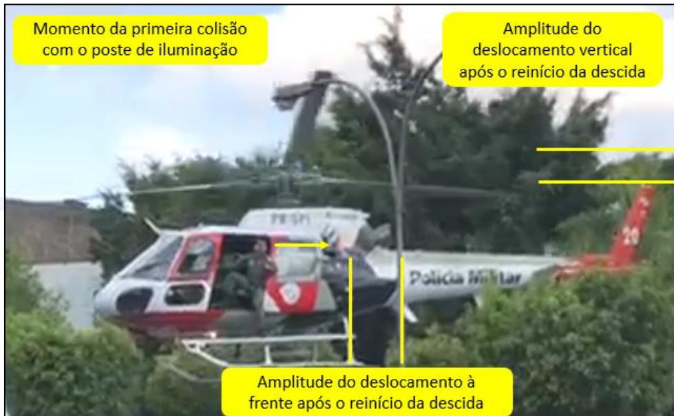
Figura 10 - Exato momento da primeira colisão do rotor principal contra o poste. Fonte: Imagem captada de vídeo cedido por observador do acidente.
