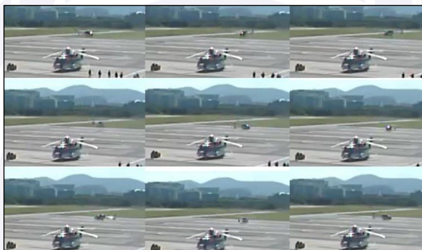
Figura 2 - Registro da trajetória do PR-FPM durante a perda de controle. Fonte: Câmeras de monitoramento do pátio de SBJR.
