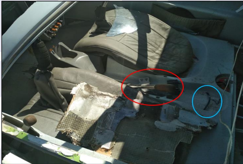
Figura 2 - Vista interna da aeronave acidentada. No detalhe, o círculo azul indica o mecanismo de travamento da alavanca do trem de pouso, e o círculo vermelho indica a alavanca do trem de pouso fora do local de travamento.
