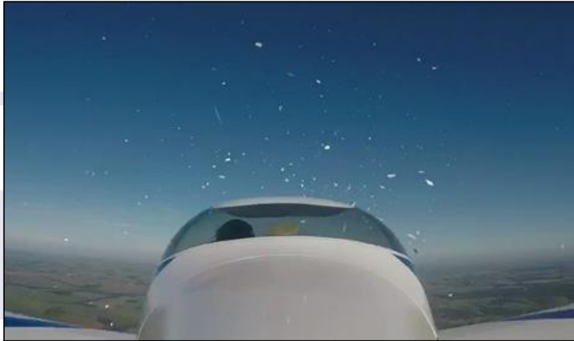
Figura 2 - Momento da fragmentação da hélice, captada por câmera de vídeo.
