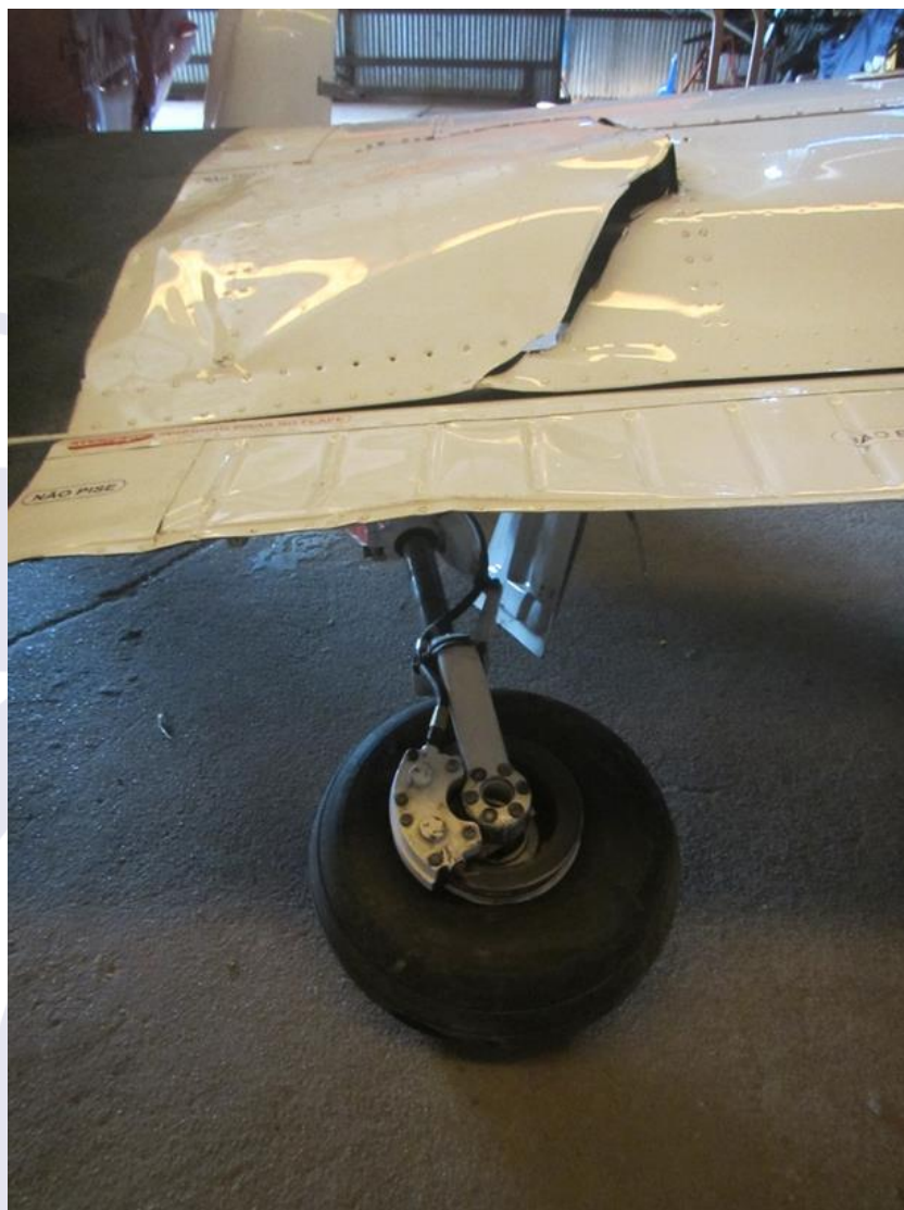
Figura 1 - Trem de pouso principal direito quebrado.
