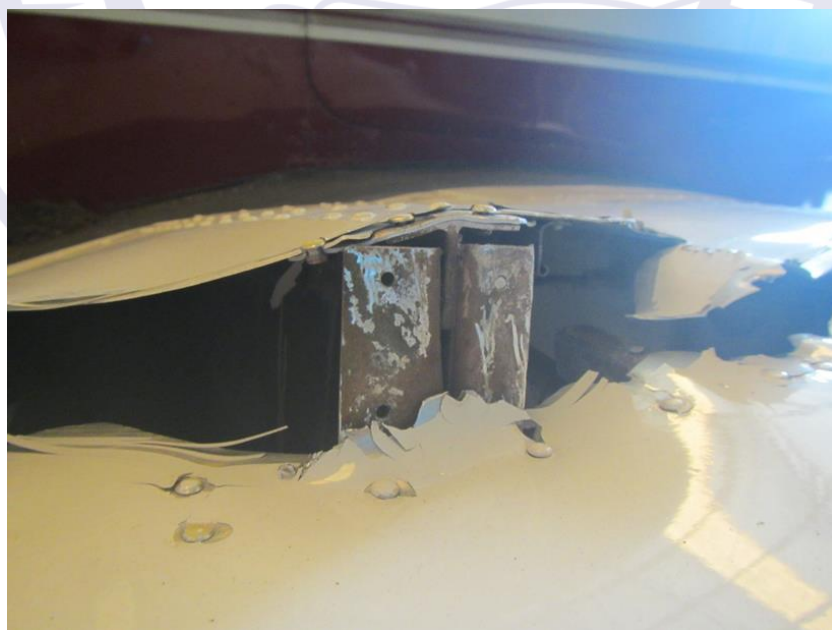
Figura 2 - Danos na asa direita causados pela quebra do trem de pouso.
