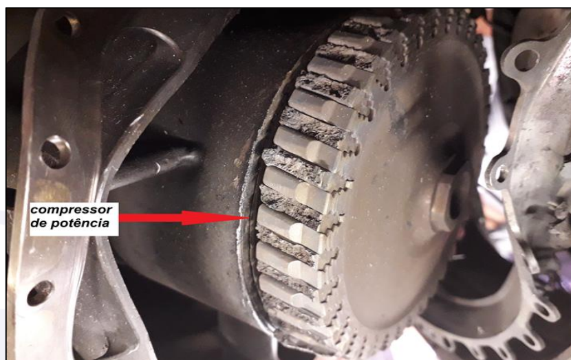
Figura 8 - Visão geral do compressor de turbina de potência com as palhetas fraturadas.
