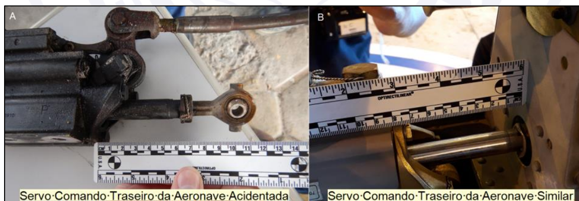
Figura 5 A e B- Posição dos servos de comandos.
