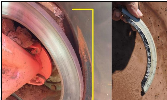
Figura 2 - Roda do trem de pouso principal esquerdo e fragmento do cubo de roda.
