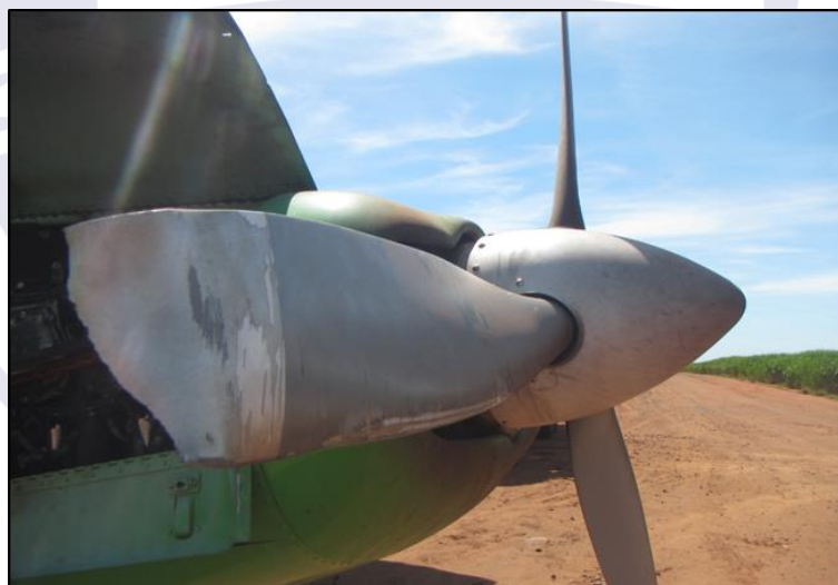
Figura 2 - Imagem da pá da hélice danificada.
