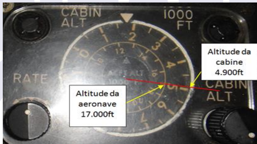
Figura 3 - Pressurization Controller indicando os parâmetros no momento da ocorrência.
