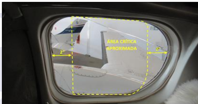
Figura 7 - Ruptura da janela na área crítica, vista do interior da aeronave.
