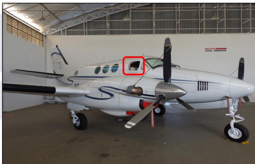
Figura 1 - Aeronave após a ocorrência (no detalhe a janela danificada).
