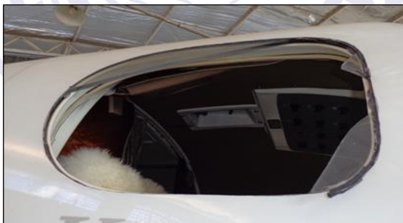
Figura 8 - Vista externa da janela da aeronave quebrada.
